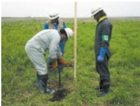
地下水位測定調査
