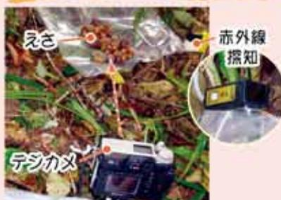
今回使用したのは、古いデジカメを改造して赤外線装置を接続したもので、赤外線がさえぎられるたびにシャッターが下りるようになっています。デジカメは、フィルムの無駄がなく、時刻も記録できる上に、その場で結果を確認できるので大変便利です。
